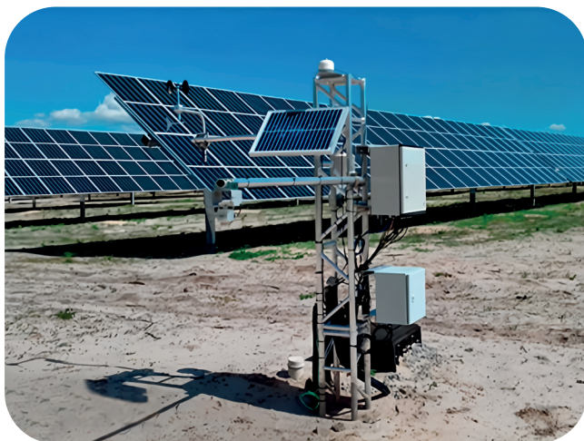
Estação Autônoma equipada com sensores: SR30, Anemômetro, Albedômetro e sensor de temperatura e umidade do ar com Alimentação Autônoma
