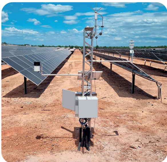
Estação solarimétrica híbrida (Rede AC e painel solar) equipada com sensores: Piranômetro SR30-M2-D1 (Em conformidade com a ISO 9060:2018 e IEC61724-1:2021 Classe A), Sensor Multiparamétrico GMX600, Pluviômetro com balsa em aço inox RG3-M e Sensor de temperatura dos módulos SS-PT1000-PVBI
