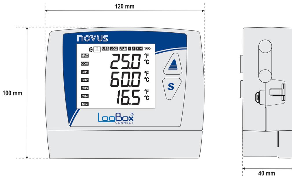
Fig. 35 – Dimensões do LogBox-3G
