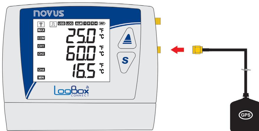
Fig. 38 – Antena GPS
