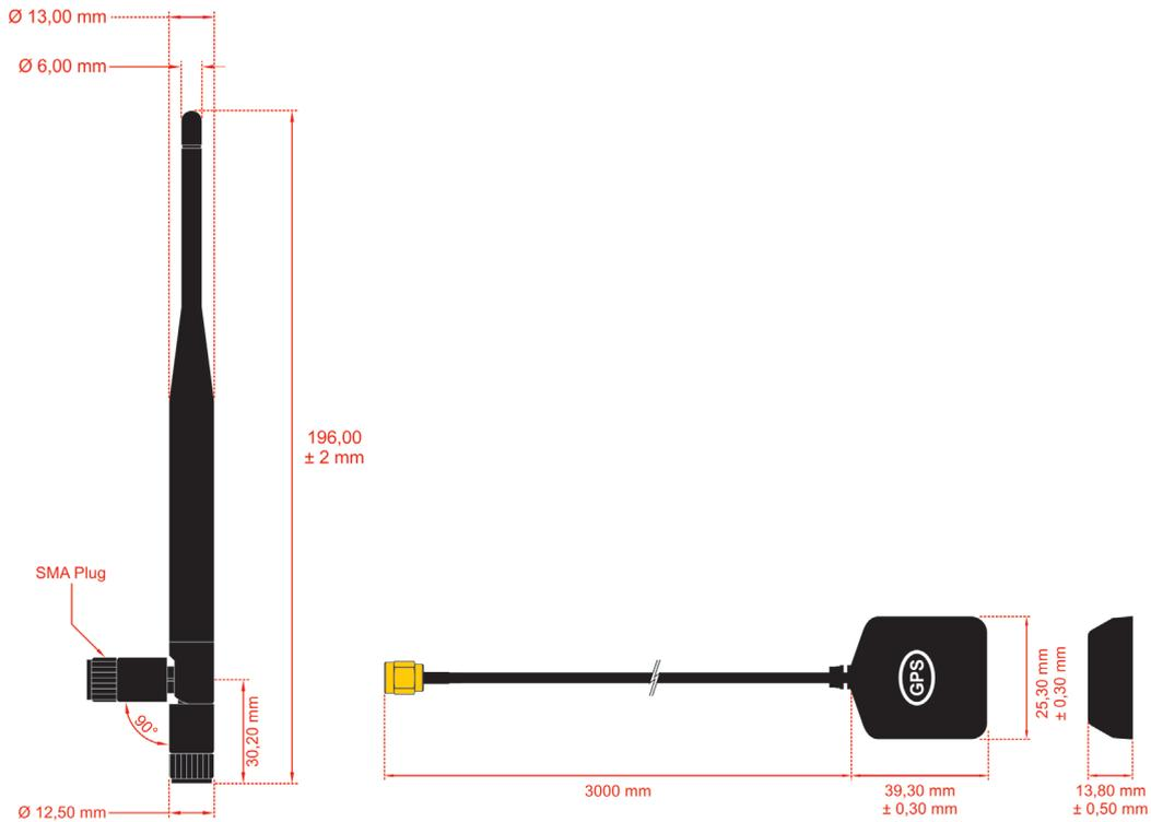
Fig. 36 – Dimensões das antenas (celular e GPS)
