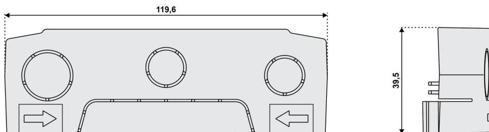
Fig. 32 – Dimensões da Tampa de Proteção das Conexões e Cavidades Destacáveis
