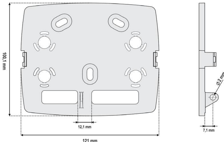
Fig. 30 – Suporte de Fixação
