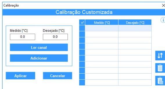
Fig. 05 – Tela de Calibração Customizada
