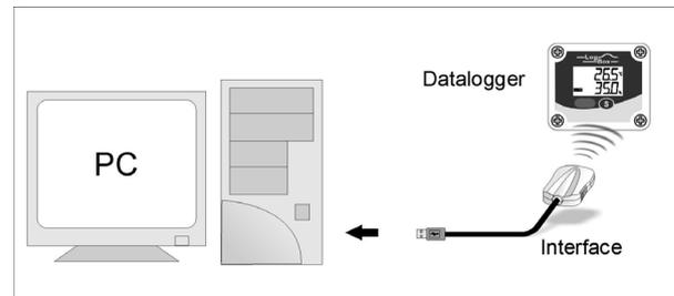
Fig. 10 – Interface de comunicação direcionada para o registrador
